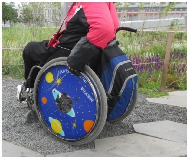
На рыхлом покрытии коляска вязнет, передние колеса разворачиваются и самостоятельно инвалид передвигаться не может
