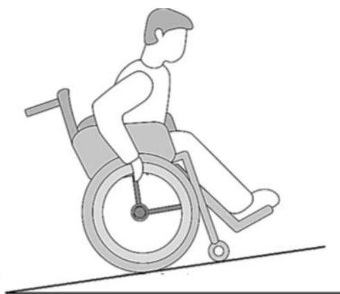
В стесненных условиях продольный уклон пешеходных путей допускается увеличивать до 8% (1:12,5) при их суммарной протяжённости не более 50 м на каждые 300 м длины
