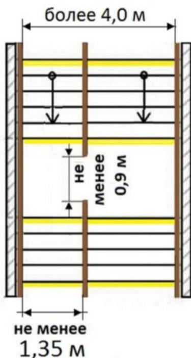
При расчетной ширине прохожей части внешней лестницы 4 м и более следует предусматривать центральные двусторонние поручни.
