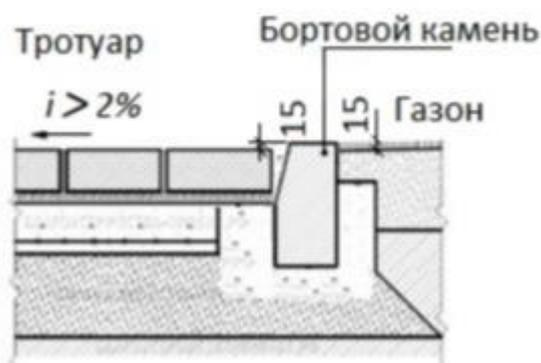
Сопряжение тротуара с газоном с допустимым перепадом высоты не более 15 мм
