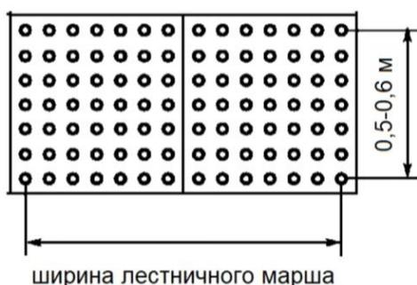
Рифы типа усеченных конусов, усеченных куполов, цилиндров, расположенных в линейном порядке
