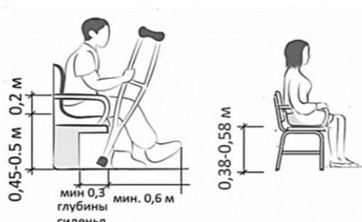
Элементы конструкции скамьи должны соответствовать требованиям ГОСТ 19120, ГОСТ 19917, не должны иметь острых углов, заусенцев, следов окисления или ржавчины. Наружные края сидений и спинок выполняются с закруглением радиусом от 0,01 до 0,05 м.
