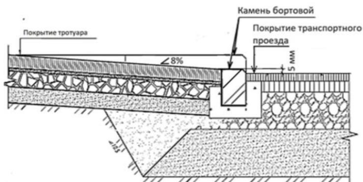
Допускается уровень примыкающей поверхности проезжей части принимать ниже на 5 мм
