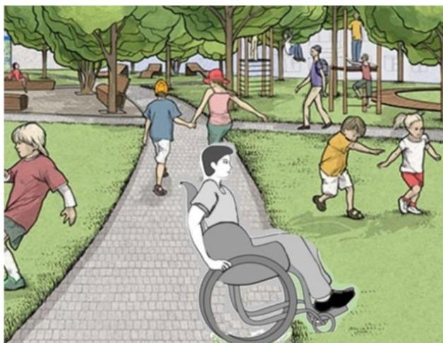
Тротуар, бортовой камень и газон в одном уровне обеспечивает возможность прохода инвалида на кресле-коляске на газон
