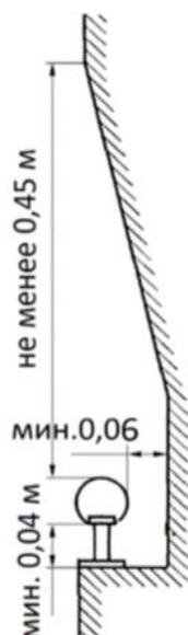
п. 5.2.3 ГОСТ Р 51261-2017: Опорные устройства могут быть расположены в нише, если эта ниша имеет глубину  $T$  не менее 70 мм и высоту  $H$  над опорными устройствами не менее 450 мм.
