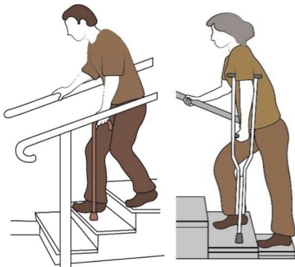
п. 5.1.10 ГОСТ Р 51261-2022: Опорное устройство должно сохранять прочность, не должно поворачиваться или смещаться относительно крепежной арматуры; должны выдерживать усилие:
