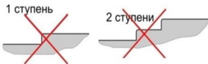
Следует исключить размещение одиночных ступеней (одна или две)
