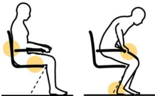
Подлокотники скамьи для МГН должны быть круглыми или овальными радиусом от 30 до 50 мм. Их верхняя поверхность должна располагаться на высоте от 0,20 до 0,23 м от поверхности сидения, а передняя поверхность – на расстоянии от 0,05 до 0,10 м от передней поверхности сидения.
