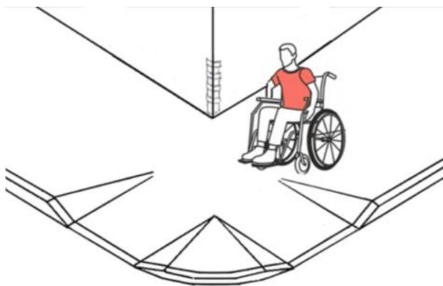
Бордюрный пандус отличается от пандуса: бордюрный пандус расположен на тротуаре (элемент тротуара), и наклонная поверхность является частью тротуара, его нижняя горизонтальная площадка расположена на проезжей части. Поручни, как правило, отсутствуют
